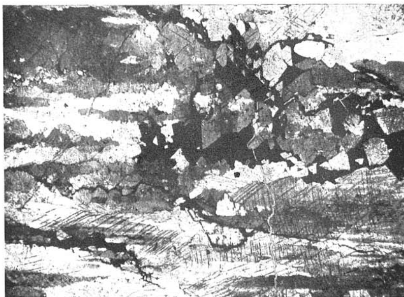
Obr. 2. Tektonicky vyvalcovaný karbonát (sivá v rôznych odtieňoch) s mladším sfaleritom (čierny) pozdĺž trhlín. Výbrus, nikoly poloskrižené, zv. 15 \times . Foto Kantor.
