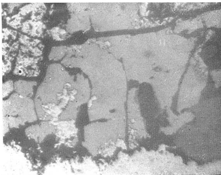
Obr. 1. Kataklastický pyrrhotín (sivý) zatlačovaný markazitom (biely, reliéf). Nábrus, zv. 410 \times . Foto Kantor.
