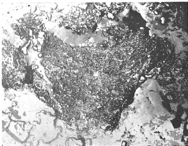
Obr. 1. Brekciovitá ruda. Uprostred úlomok jemnozrnných sulfidov s hojným guľôčkovitým vývojom (viditeľný hlavne pyrit). Okolo útržku prevažne pyrhotín (biely), kryštalický pyrit (biely, reliéf) a sfalerit (sivý). Nábrus, zv. 28 \times . Foto Kantor.
